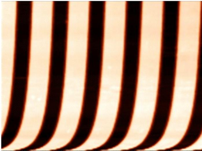
Рис. 5.2 Крип в плоскости XY после смещения области сканирования.
