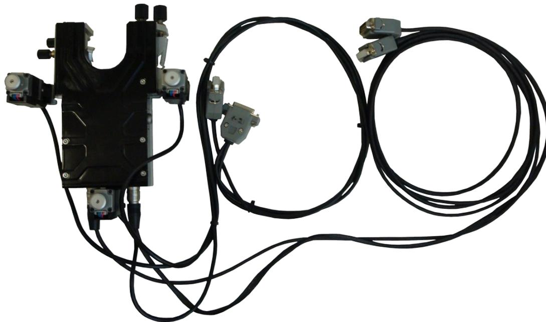
Рис. 3.6 Общий вид сканирующей головки со всеми кабелями.
