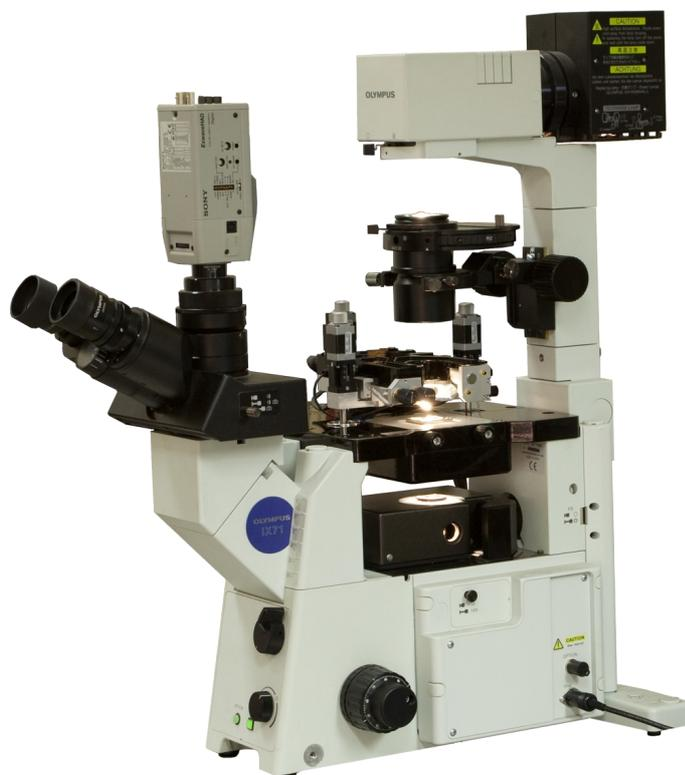
Рис. 6.4. Совмещение с инвертированным оптическим микроскопом.
