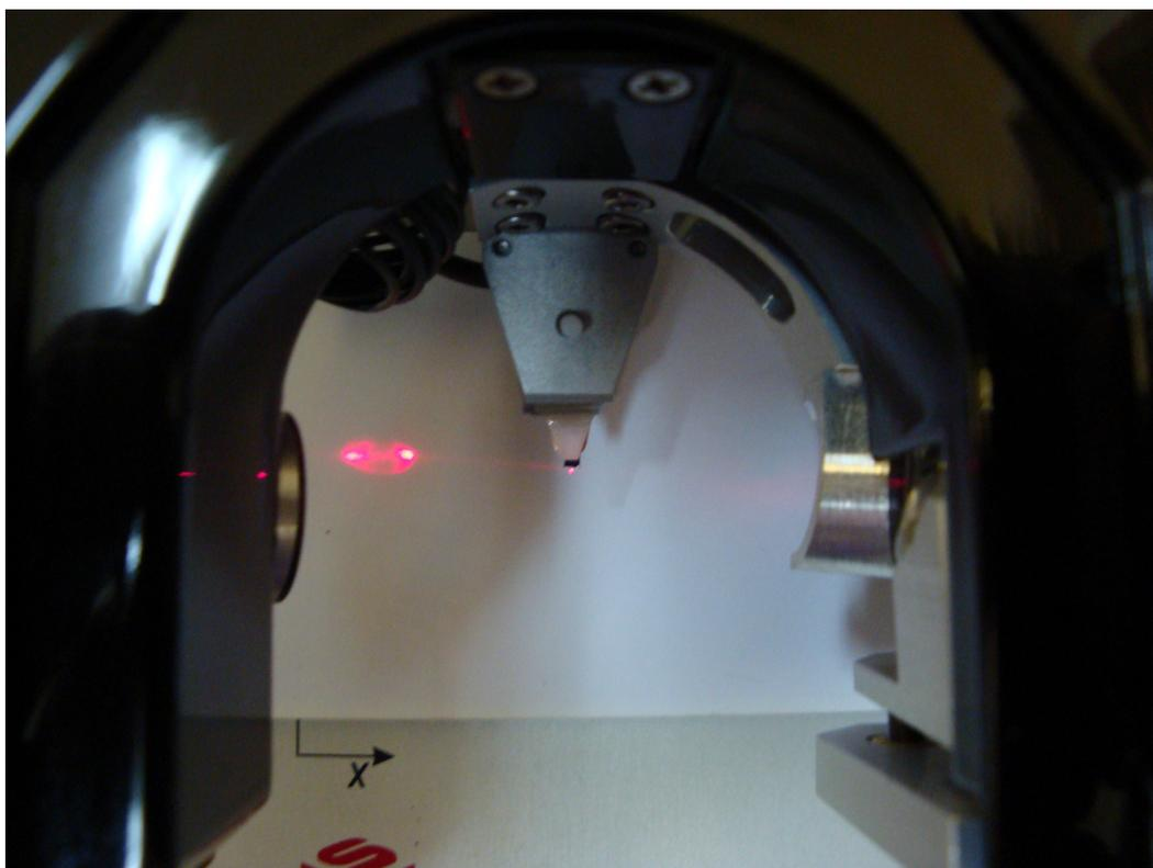
Рис. 4.16 Вид лазерного пятна при попадании на балку кантилевера.
