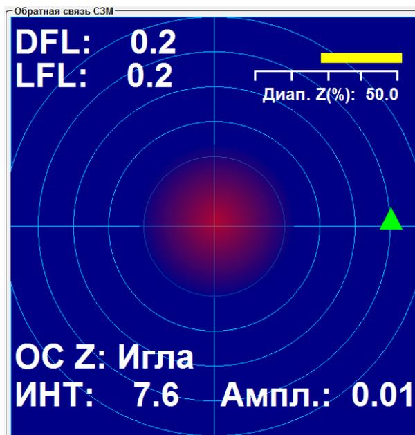
Рис. 4.21 Лазерное пятно в центре фотодиода.
