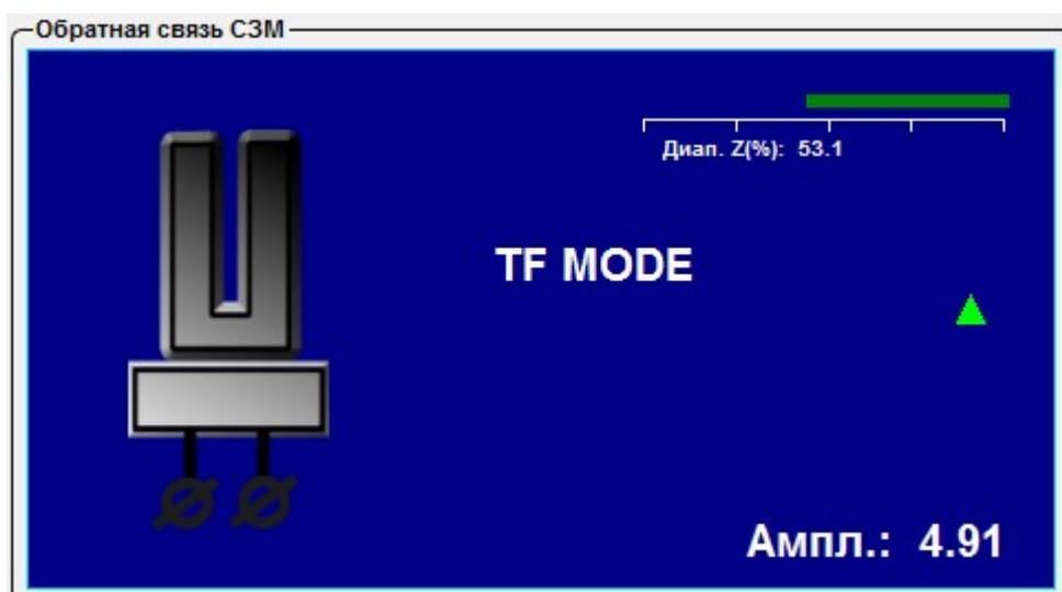
Рис. 4.28 Переключение в режим резонансной микроскопии при использовании кварцевых резонаторов.
