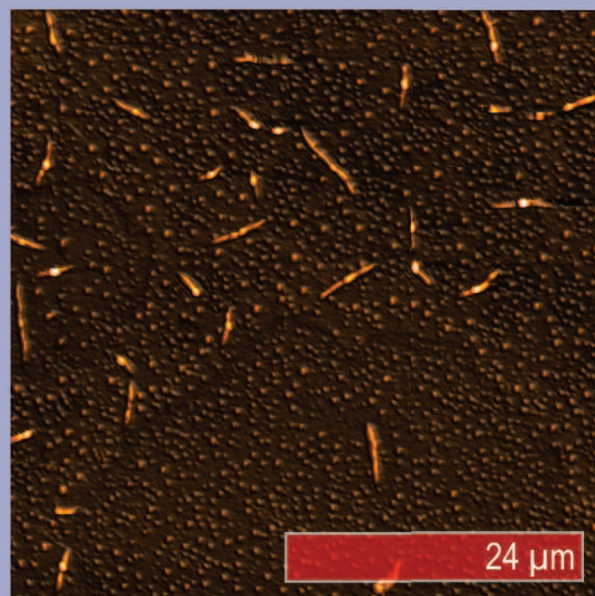
Фосфолипидная пленка. Полуконтактный режим сканирования. Топография. 400x400 точек.
