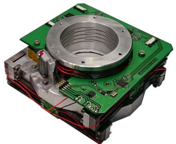
Рис. 3 Сканирующий пьезостолк Ratis XYZ_H с использованием оптических энкодеров.
